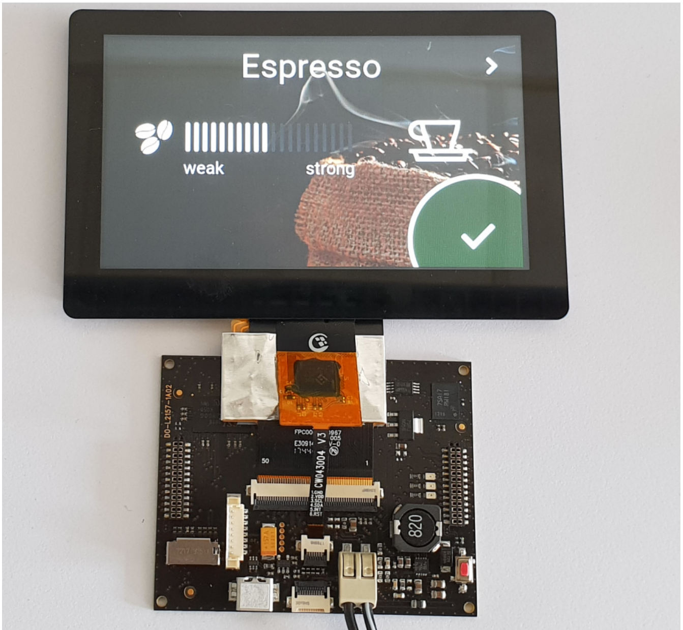
Abbildung 8: LIZARD-Board mit fertiger Benutzerschnittstelle
