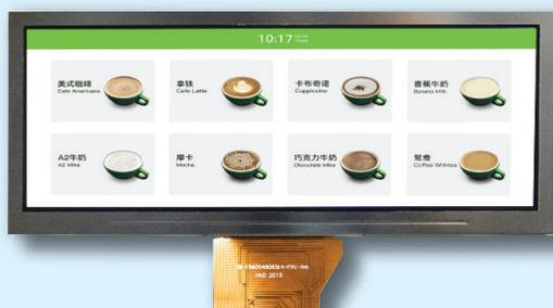
Viele Standarddisplays können auf die benötigte Höhe zugeschnitten werden, z.B. kann ein typisches 4.3" mit 480x272 Auflösung, auf 480x120 gestutzt werden und passt somit in ein 1HE Gehäuse. Der Schnitt muss immer parallel zur Kante mit dem Controller erfolgen, da ansonsten zwingend benötigte Datenleitungen durchtrennt werden. Eine kundenspezifische Lösung lässt sich bereits ab ca. 2.000 - 3.000 Displays pro Auftrag realisieren - dies bei relativ geringen Einmalkosten.
